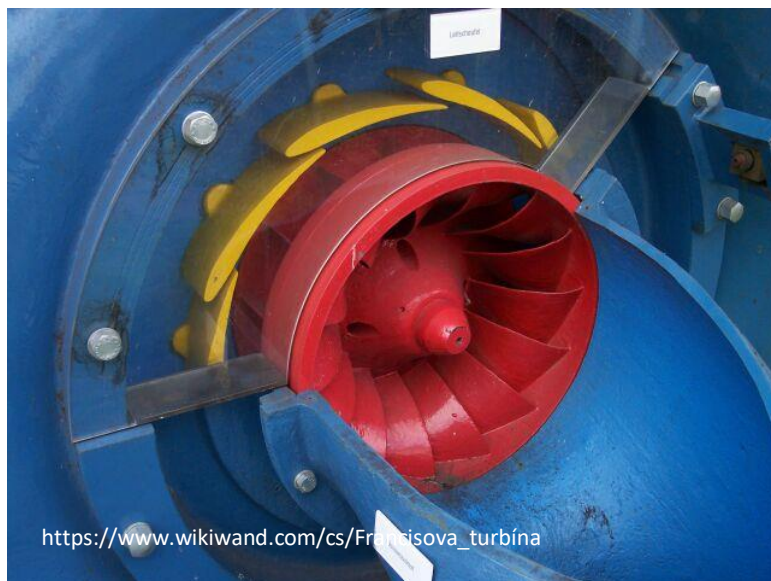
Reverzní Francisova turbína určená pro střední průtoky.
