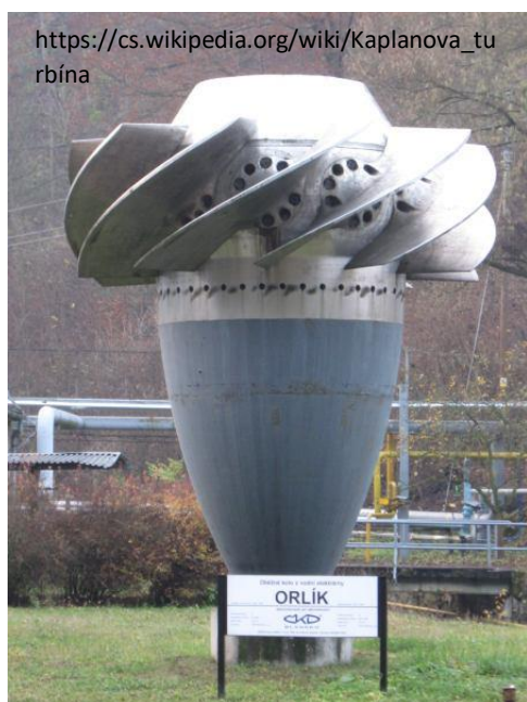
Kaplanova turbína použitá např. v elektrárně na Orlíku.
